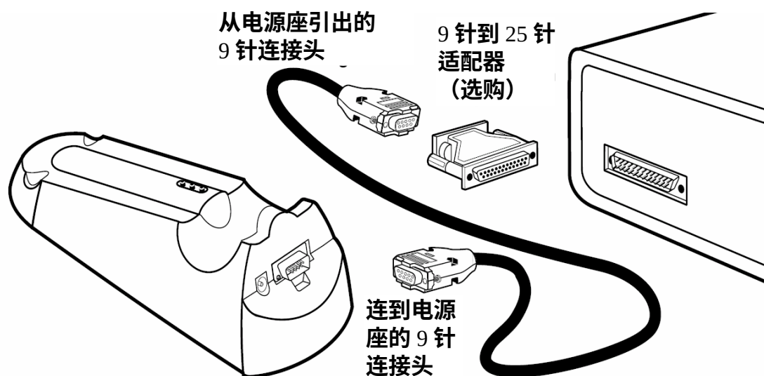
图 8 RS232 缆线连接
